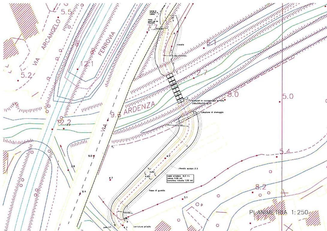
In questo caso si prevede di realizzare un percorso in rilevato più lungo, ma più basso, con un attraversamento a guado realizzato impiegando degli scatolari prefabbricati in cls di dimensioni tali da garantire il normale deflusso delle acque; i costi sono di poco superiori alla soluzione B) e viene mantenuta una maggior distanza dal cantiere per la deviazione del fosso.
