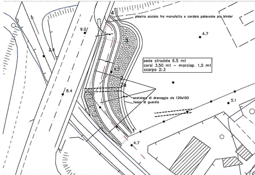
L'ipotesi progettuale prevede la realizzazione di rampa in rilevato con una pendenza max del 10% mediante infissione di una batteria di palancole per il contenimento del rilevato. Tale soluzione comporta un costo elevato a causa delle cattive caratteristiche del terreno di fondazione e quindi del dimensionamento necessario oltre che della difficoltà dei mezzi operativi per l'infissione e i tempi di fornitura;
