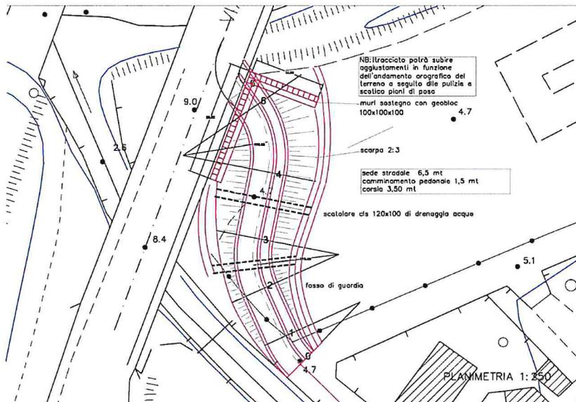
A differenza della soluzione A), per il contenimento del rilevato possono essere impiegati blocchi in cls prefabbricato a incastro tipo geobloc che sono di facile reperibilità e senza particolari difficoltà di posa in opera, oltre che di facile rimozione e reimpiego;
